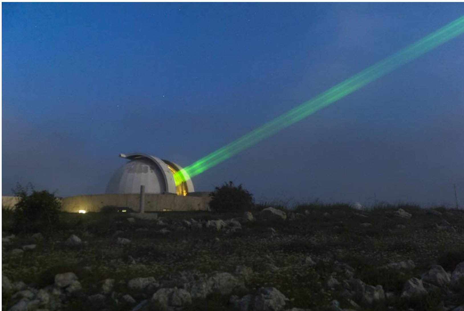
Faisceau laser issu du télescope Méo permettant d'effectuer des mesures de distances Terre-Lune par télémétrie laser © Cyril FRESILLON / GEOAZUR / FIRST-TF / CNRS Photothèque
