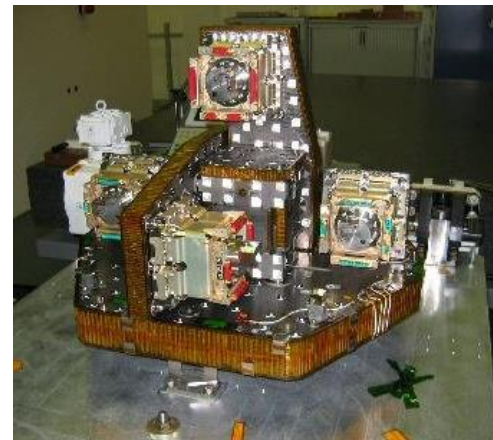
GOCE: accéléromètres électrostatique. Ne fonctionne que en microgravité.
