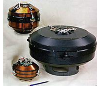
Gradiomètre Lockheed Martin: deux paire d'accéléromètres installé dans un disque rotatif
