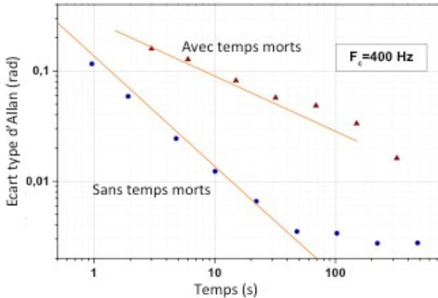
Ecart type d'Allan de phase en fonctionnement de type horloge de Ramsey pour  $T = 480$  ms et utilisant de une fréquence de Rabi de 14 kHz. Du bruit blanc de phase est ajouté dans la bande 0-400 Hz. Les triangles rouges correspondent à un fonctionnement normal avec temps morts et une durée de cycle de 1,5 s. Les points bleus correspondent au fonctionnement jointifs. Les lignes correspondent aux simulation avec une décroissance respective comme la racine du temps de mesure ou son inverse.
