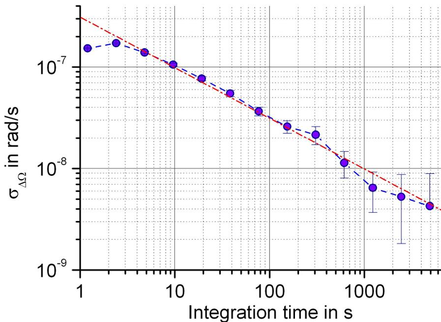
Ecart type d'Allan des variation de vitesse de rotation pour une configuration à quatre impulsions et une durées d'interrogation de 480 ms, correspondant à une aire physique de  $2,4 \text{ cm}^2$ .
